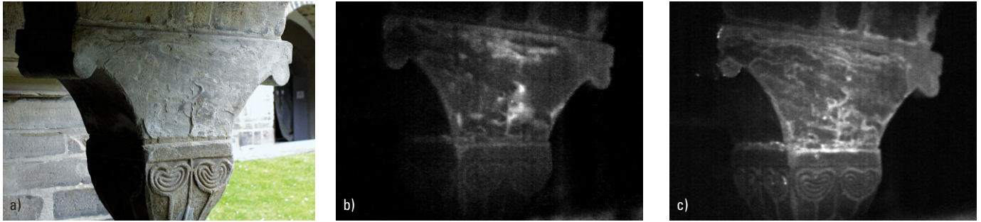
Bild 1. a) Kämpfer einer Säule im Kloster Unser Lieben Frauen in Magdeburg. b) Differenzthermogramm nach einer Impulsanregung von 1 min (dunkel bis Hell: 0 bis 1,2 K). c) Amplitudenbild bei periodischer Anregung mit 0,25 Hz, Messzeit 1,5 min
