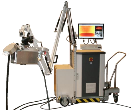
Abbildung 7: Hand-Prüfplatz zur manuellen Schweißverbindungs-Prüfung
