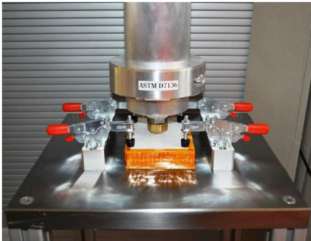
Abbildung 2: Drop-Weight-Impact-Tower mit eingespanntem Probekörper
