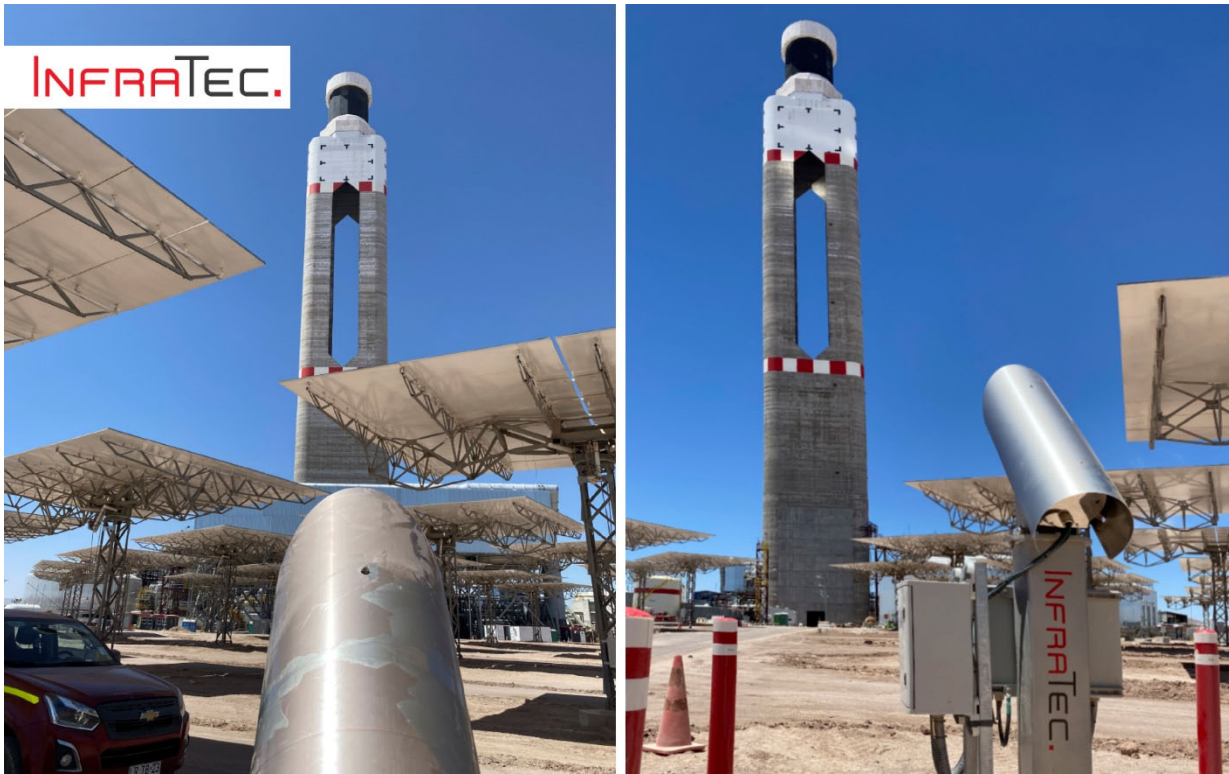
Abb. 1: Infrarotkamera von InfraTec: zwischen den Spiegeln des Solarfeldes, rund um den Solarturm in der Atacama-Wüste, ausgerichtet auf den Receiver des Turmes
