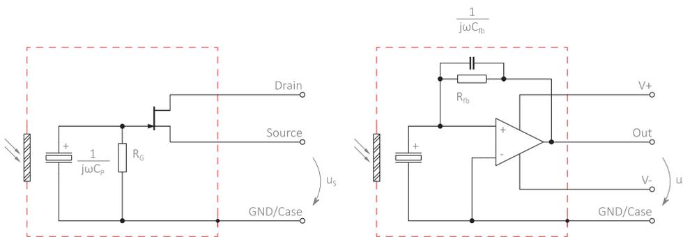
Abbildung 5: Vorverstärkergrundsaltungen im Spannungs- und im Strombetrieb
