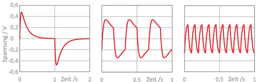
Abbildung 9: Typische Signalformen eines Strombetriebsdetektors am Beispiel eines LME-335 bei 0,5 Hz, 3 Hz und 10 Hz (v.l.n.r.)
