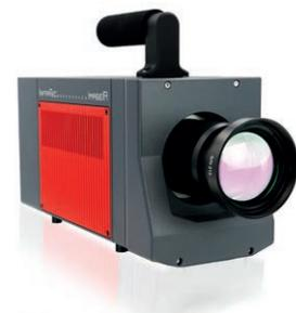
Das Multispektralfeature ermöglicht es, Sequenzen mit kontinuierlich wechselnden Spektralfiltern aufzunehmen. Die Bildaufnahme erfolgt dabei synchron zu einem mit den Filtern bestückten, schnellen Filterrad. Je nach Ausführung kann zwischen bis zu sieben Filtern gewechselt werden. Dadurch kann die Multispektralmessung des Kamerasystems auf die spektralen Eigenschaften der jeweiligen Messobjekte optimiert werden, sollten die voreingestellten Bereiche ungeeignet sein.
