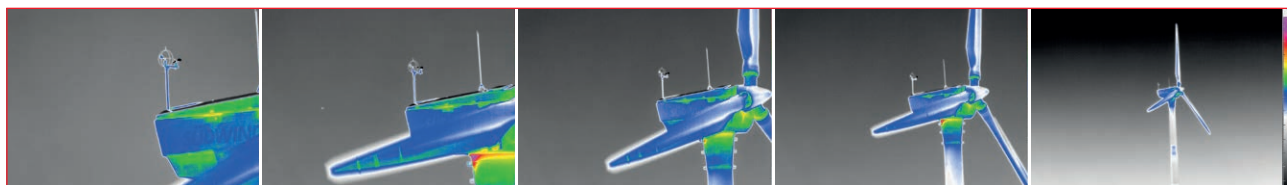
Thermografische Aufnahme einer Windkraftanlage mit verschiedenen Zoomstufen
