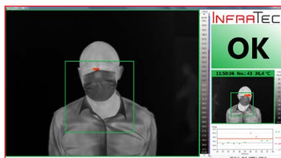
Sobald sich der Proband im gekennzeichneten Bereich (grünes Feld Bildmitte) befindet, erfolgt die Messung
