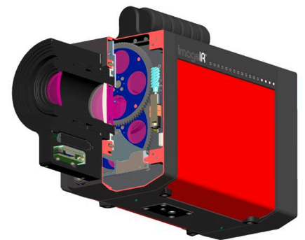
Schnittdarstellung einer Motorfokuseinheit
