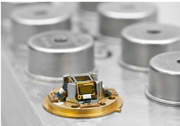
Vierkanaldetektoren von InfraTec mit vierseitigen Mikropyramiden zur Aufteilung der Infrarotstrahlung.
