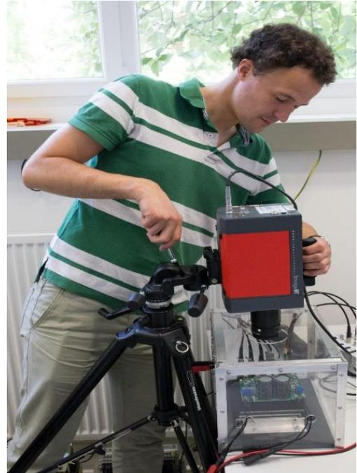
Abb. 3: Dr. Markus Andresen während der Ausrichtung der Wärmebildkamera für Tests zur Validierung von Aktiver Thermischer Regelung
