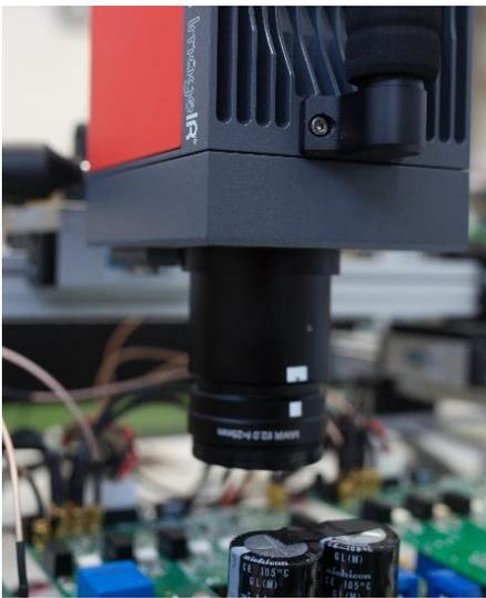
Abb. 2: Thermisches Setup mit Wärmebildkamera und offenen Halbleitermodulen zur thermischen Evaluation der Halbleiter während des Betriebs
