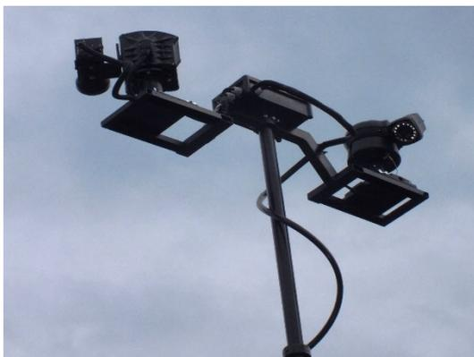
CCTV-System mit Wärmebildkamera VarioCAM®-Serie
