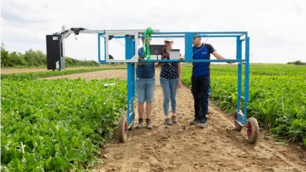
Abb. 1 Der Messaufbau zur Ermittlung der Blattemperatur mit Wärmebildkamera und Monitor.
