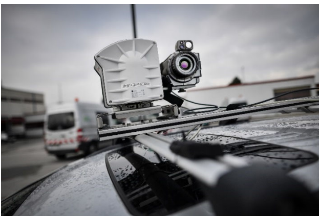
Abb. 3 Spezialkonstruktion mit Schwenk-Neigekopf auf dem Dachträger.
