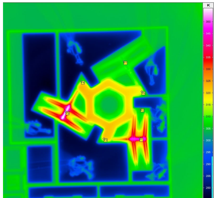
Abb. 1: Thermografiebild eines MEMS-gesteuerten Aktors mit drei Freiheitsgraden und thermischen Antrieben
