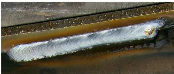
e) Farbaufnahme einer defektfreien Schweißnaht
