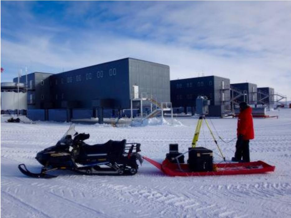
Das LIDAR-/Thermografiesystem im Einsatz an der Südpolstation. Der thermische Mantel um die beiden Sensoren auf dem Stativ wurde speziell für diese Untersuchung entwickelt, um die Mindestbetriebs-temperaturen für beide Sensoren zu gewährleisten. Ein Generator, der in dem Gehäuse auf dem Schneemobilschlitten untergebracht ist, versorgt sowohl das System als auch den Wärmemantel mit Strom.
