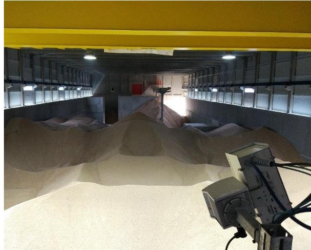
Abb. 2 Ein Blick ins Pellet-Lager, rechts die VarioCAM® HDx head auf einem automatisierten Schwenk-Neige-Kopf
