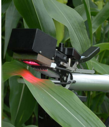
特写：温度控制的叶片比色皿和人工光源
