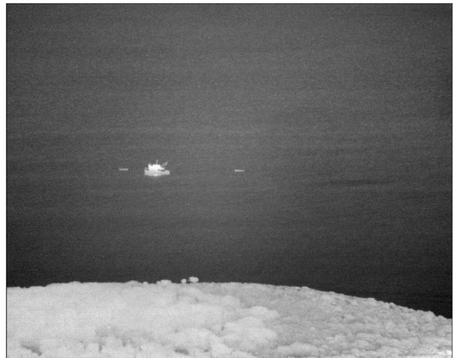
Abb. 4 Aufnahme mit Wärmebild-Zoomkamera ImageIR® 9300 Z unter Verwendung des 30x Zoom – 1.3 x 1.0° Bildfeld
