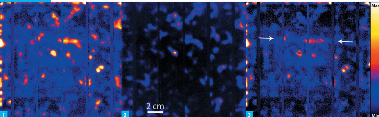
**Abb. 1:** Gesamtstrom bei 0,53 V und einer Stromdichte von 0 bis 5 mA/cm<sup>2</sup>
