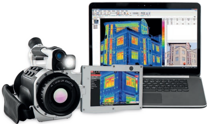
Bild 5. Im Zusammenspiel aus Kamera, Software und weiterem Zubehör lassen sich Verfahren wie die Aktiv-Thermografie auch auf die Bauthermografie übertragen (Fotos: InfraTec)
