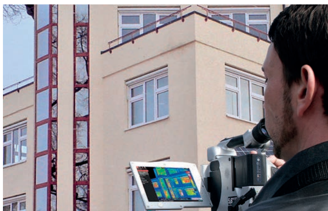
Bild 1. Das 5,6" große Farb-TFT-Display der VarioCAM® High Definition erlaubt eine erste Analyse der Aufnahmen bereits vor Ort
