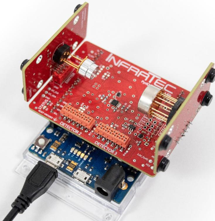
安装了热释电探测器和红外光源的 PyrIQ® 评估套件
